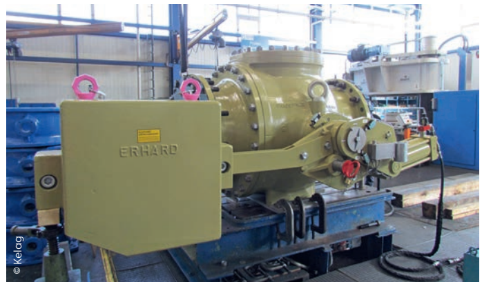
Zentrales Verschlussorgan: Der Kugelhahn DN800 von der Firma ERHARD bei der Werksabnahme
